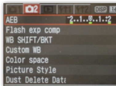
Canon Rebel XT/400D - Lo schermo LCD mostra una impostazione AEB con intervalli di +/- 2 EV
